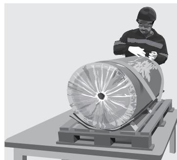
**Fig.2.2.B** – A colocação de uma plataforma fixa de 55cm de altura possibilitou que a atividade passasse a ser feita na posição ereta, sem desconforto e mais rapidamente
