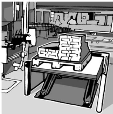
**Figura 2.3** – O *pallet* é colocado sobre uma mesa elevadora, evitando que o operador tenha que encurvar o tronco para alcançar as caixas mais inferiores
